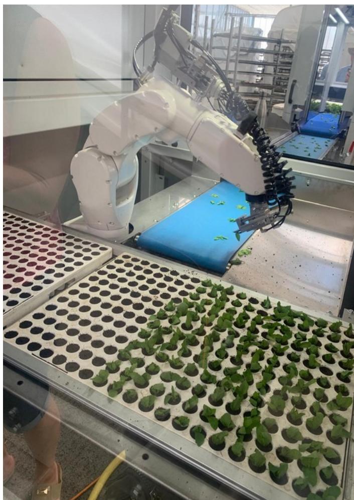
Ein hochmoderner Roboterarm erkennt oben und unten der Stecklinge und steckt sie in die Pikierplatten.
